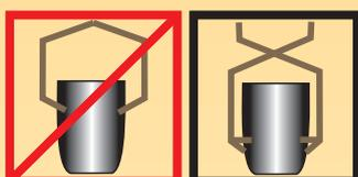
Для установки и извлечения тиглей следует применять клещи (захваты), соответствующие форме тигля, обернутые мягким материалом.
