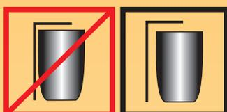
Промежуток между тиглем и крышкой печи должен быть изолирован термоизоляционным материалом.
