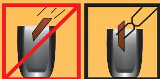
Металл загружать только в разогретый тигель. Металл должен быть сухим и слегка подогретым. Большие куски следует вводить в тигель клещами, не допуская их соударений с тиглем.
