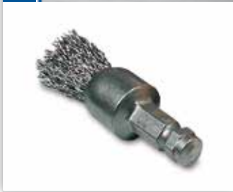
Дисковая щетка D50, быстрозажимаемый хвостовик, гофрированная стальная проволока 0,30, нейтральная / без упаковки, макс. 4 500 об/мин
