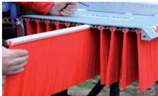
Кожух из оцинкованной стали, облегчающий демонтаж щеток, предлагается в разной ширине.
