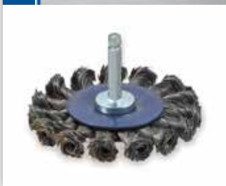
Дисковая щетка D50, быстрозажимаемый хвостовик, гофрированная стальная проволока 0,30, нейтральная / без упаковки, макс. 4 500 об/мин
