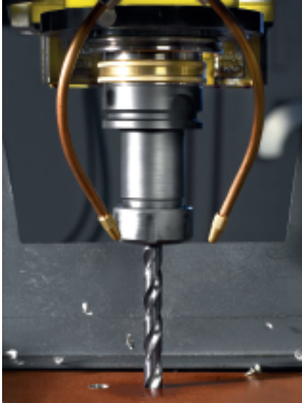
Perforación totalmente automatizada combinada con corte térmico en la misma pieza
