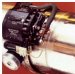
Cabezales para grandes diámetros de tubería, con funciones de alimentación de alambre, oscilación y control de altura automático.
