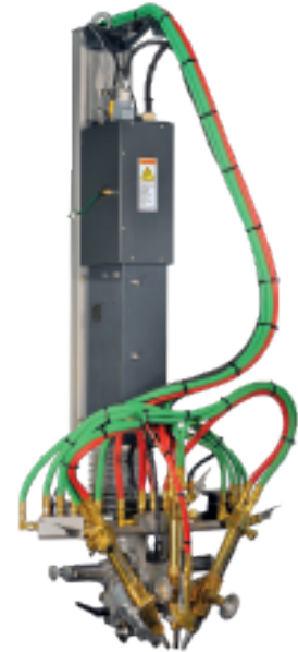
Sistema de corte biselado con proceso oxicorte, con capacidad de biseles I, V, Y, X, y K . Cabezal con giro manual.
