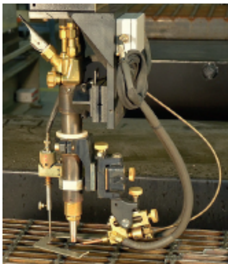
Sistema de corte para rejillas metálicas con proceso oxicorte
