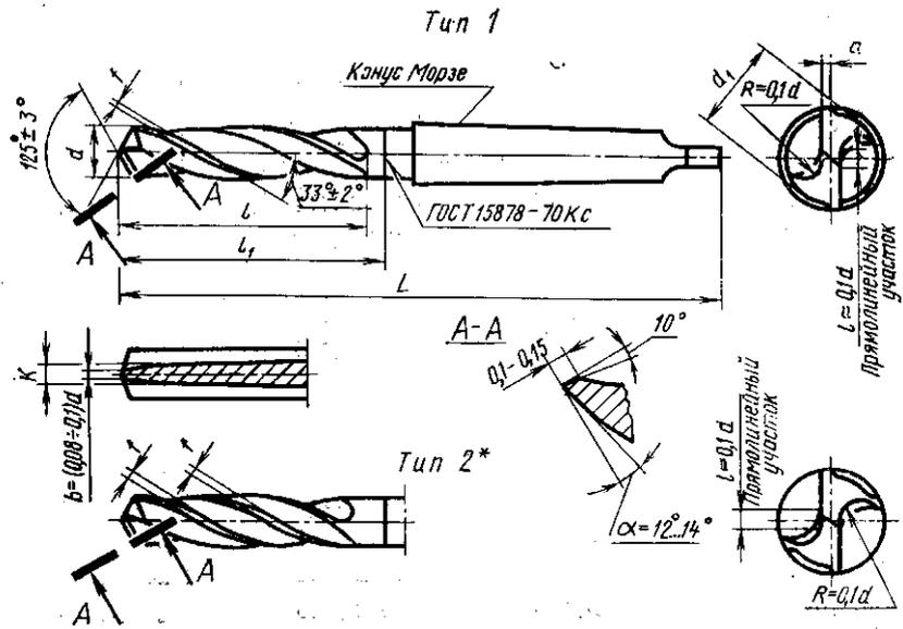
\* Для обработки отверстий 4-го класса точности.
